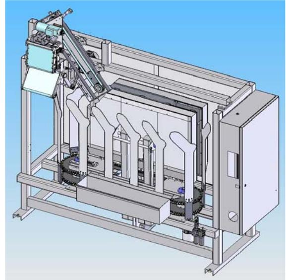
La machine est disponible avec un alignement du bord cote, et un défileur double qui permet d'augmenter la productivité jusqu'à 600 paires par heure. La capacité de la machine passe alors à 14 formes.
